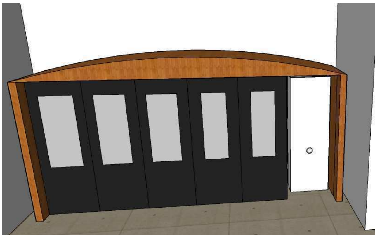
Obr.7 – Opláštění rámu – LTD desky (bílá barva) – usazení v boxu pro automaty – lze zvolit jiné umístění v rámci boxu (variabilita).
