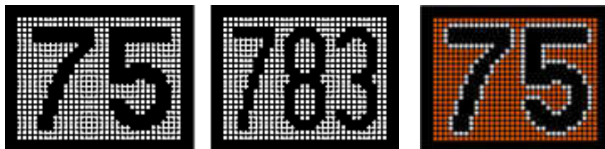
Příklady zobrazení ZL1 na zadním a levém bočním panelu s inverzním zobrazením čísla linky.
