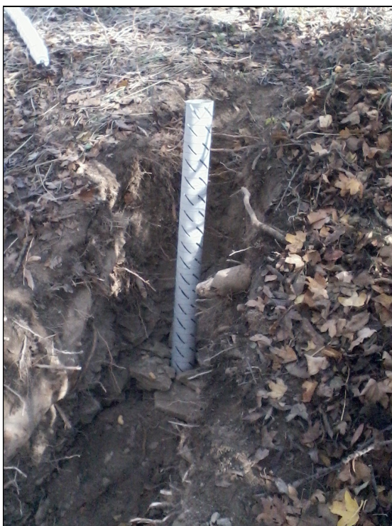
Obr. 5. Varianta podzemních pastí – instalace vnějšího pláště do profilu sutě vyžadující jeho odkrytí v celé délce instalované pasti a uspořádání výměnných pastových kelímků na centrální kovové ose (foto V. Růžička a I. H. Tuf).
