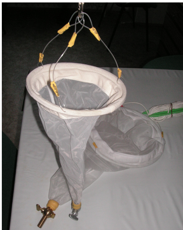
Obr. 8. Planktonka pro sběr vodní mikrofauny (vlevo, zdroj: Jana Říhová Ambrožová, Encyklopedie hydrobiologie, Elektronická publikace, verze 1.0, 2006) a sítko (cedníky) pro přímý sběr vodní makrofauny.
