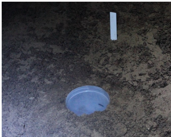
Obr. 2. Příklad instalované padací pasti bez návnady s plastovým štítkem pro vyznačení čísla stanoviště a pasti v jeskynním prostředí (Tajovský a kol. 2016).
