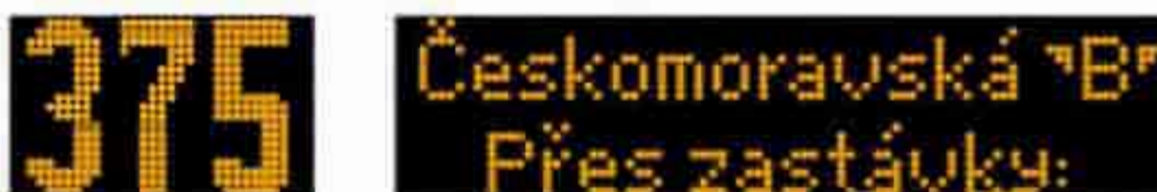
Obrázek 7: Správné použití rozděleného bočního panelu
