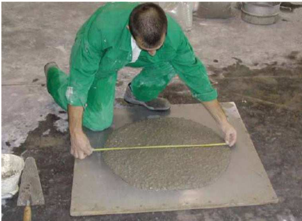
(3) Obr. 3 – Zkouška rozlití SCC - správně navržená směs
