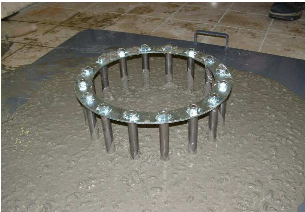
(10) Obr. 10 – Zkouška SCC J-kroužkem – správně navržená směs, bez blokace a segregace u výztuže (skelet J-kroužku)
