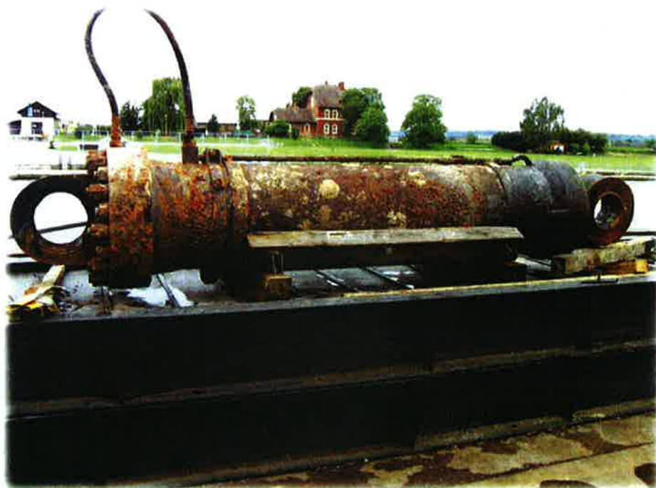
Příklad stejného typového hydromotoru před opravou
