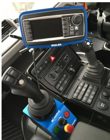
Ovládací pult s joystickem Mulag M/Control
