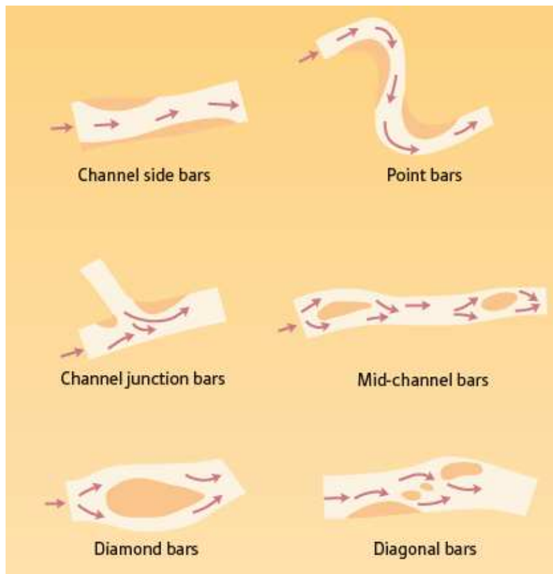
Obr. 63: Typy lavic: střídacé (i v upravených korytech, nejméně stabilní), zákrutové (jesepní), výústní (přítok přináší sediment), střední (málo stabilní, zpravidla za překážkou), diamantové (stabilnější, může se uchytit i vegetace), příčné (narušení diamantových); obrázek převzat z Holden (2017)
