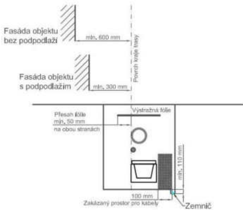
Obrázek 4 - Společná pravidla pro uložení kabelů
