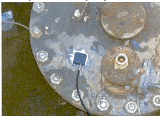
Obrázek A.7: Povrchový senzor SMS připevněný k trubě
