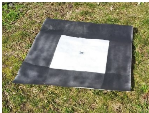
Obr. 2. Rozměry a způsob signalizace bodu geotextilií
