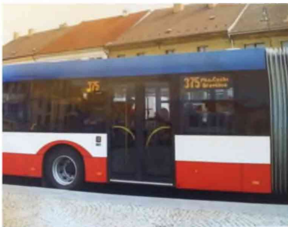
Obrázek 6: Nesprávné použití rozděleného bočního panelu
