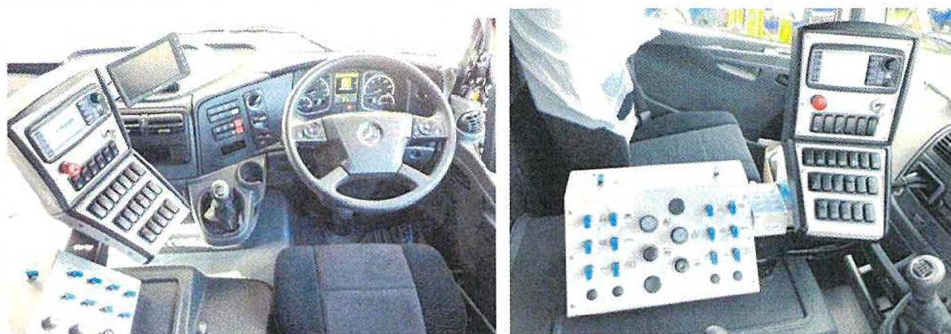
Pracoviště řidiče vozidla s 2-dílným ovládacím panelem nástavby zametače Faun Viajet v prostoru mezi sedadly a monitorem kamerového systému. Na displeji hlavního pultu jsou indikovány provozní údaje nástavby a sepnuté funkce
