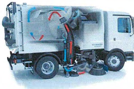
Koncepce zametacího stroje FAUN Viajet – oběhový systém vzduchu, certifikace PM 2,5 a PM 10
