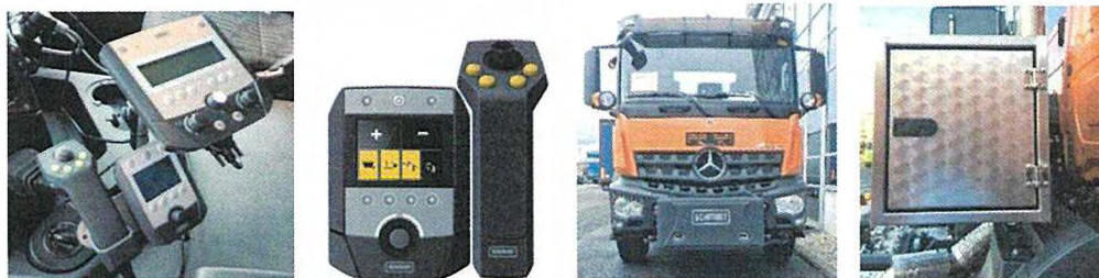
Systém ovládání pluhu a čelních nástaveb Schmidt ESC-A a ESC-J a výbava podvozku
