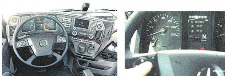
Přístrojová deska MB Arocs s informačním displejem se zobrazením funkcí, provozního stavu vozidla, ukazatelem servisního intervalu a případných závad
