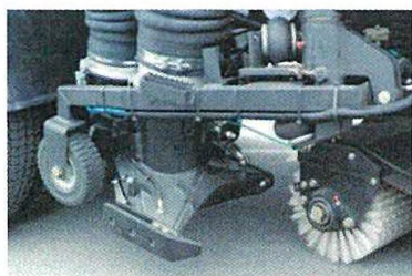
Nové provedení sacího vozíku s V-profilem sacího ústí a přífukem vzduchu
