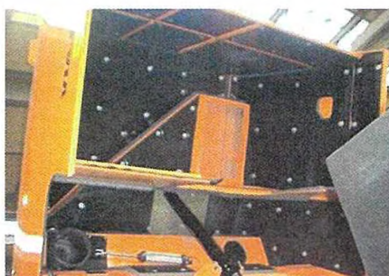
Vnitřní odlučnění skříně (Silent Plus)
