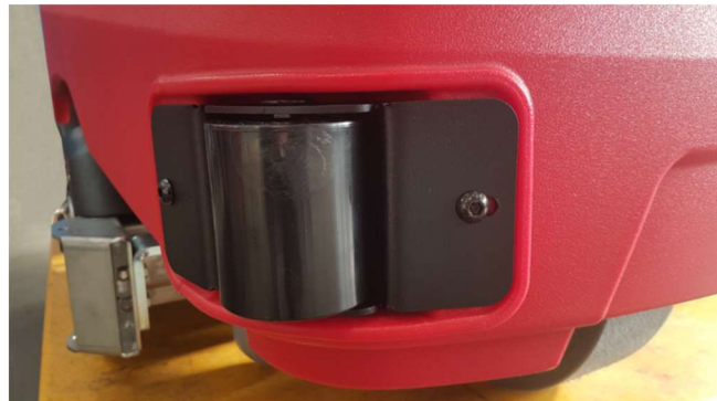
nárazníky v rohu nádrže
