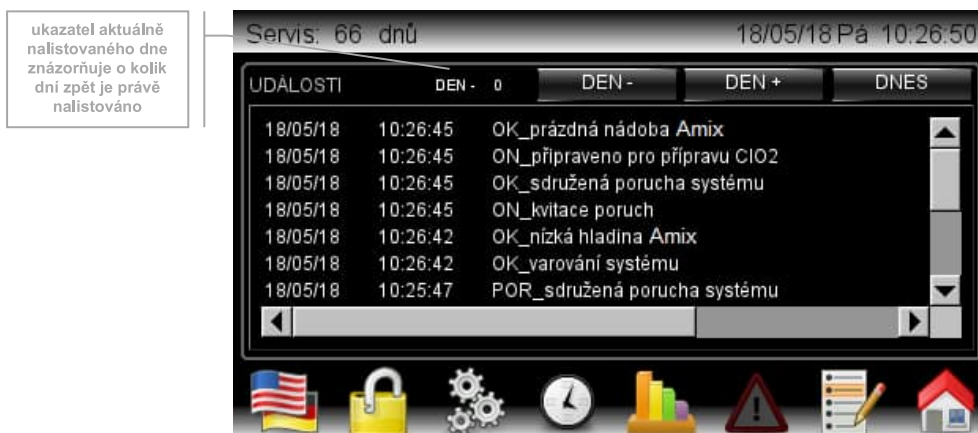
Obr. 9: Výpis historie poruch, varování a událostí řídicího systému
