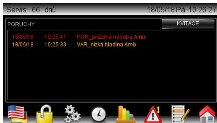
Obr. 8: Výpis aktuálních poruch a varování řídicího systému
