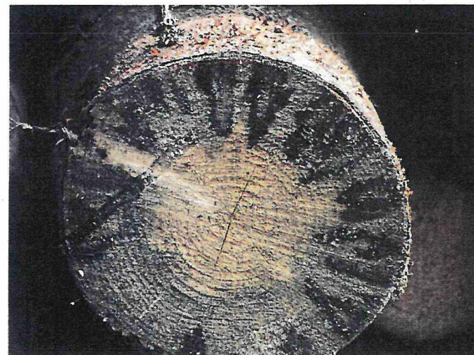
Zamodráni větší než ¼ tloušťky čela čepu
