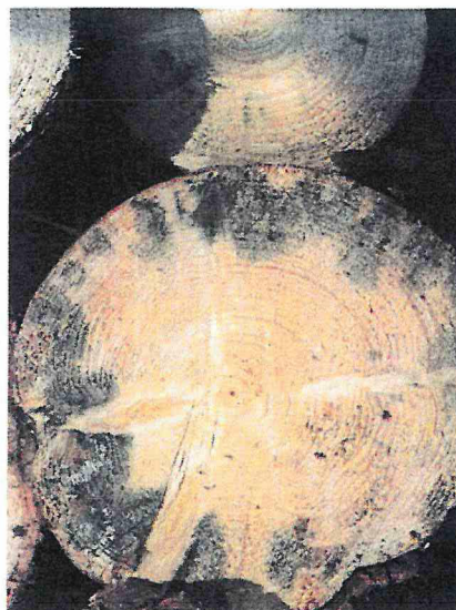
Zamodráni větší než ¼ tloušťky čela čepu a počínající paprsky hniloby!
