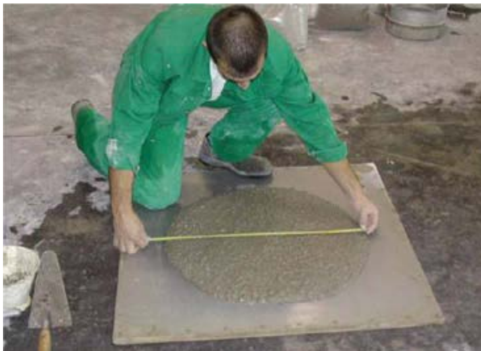
(3) Obr. 3 – Zkouška rozlití SCC - správně navržená směs
