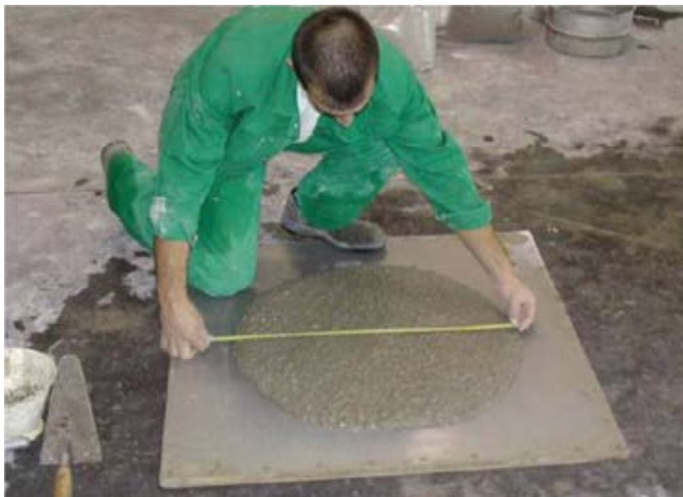
(3) Obr. 3 – Zkouška rozlití SCC - správně navržená směs
