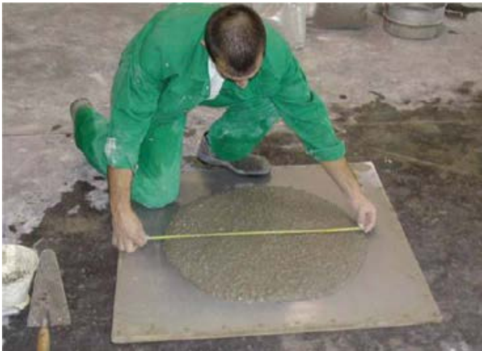
(3) Obr. 3 – Zkouška rozlití SCC - správně navržená směs
