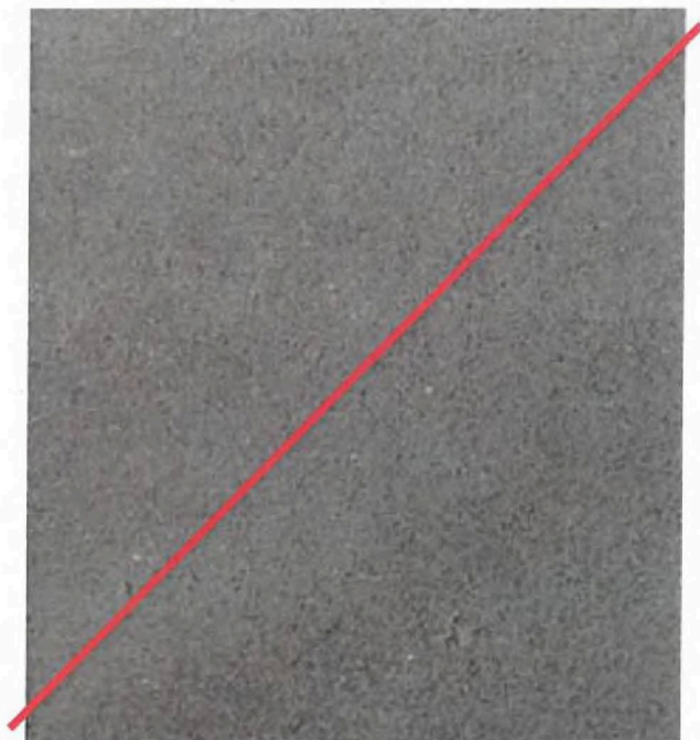
25 Betonová dlažba — povrch standardní (přirodní) šedý, bez tryskání; povrch vhodný pouze pro dlažbu distanční. Foto 1 : 1
