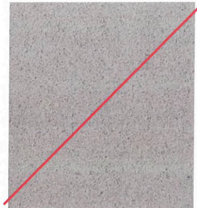
27 Betonová dlažba — povrch standardní bílý, bez tryskání; povrch vhodný pouze pro hmatné dlažby. Foto 1 : 1
