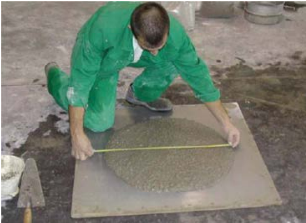
(3) Obr. 3 – Zkouška rozlití SCC - správně navržená směs
