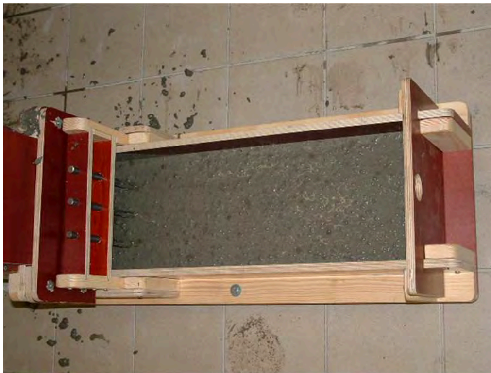
(7) Obr. 7 – Zkouška SCC L-truhlíkem – správně navržená směs, bez blokace, bleedingu a segregace hrubých zrn
