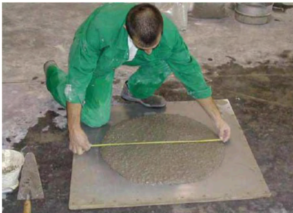
(3) Obr. 3 – Zkouška rozlití SCC - správně navržená směs
