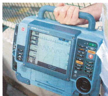
LGD obrazovka s dvojím režimem zobrazení a displejem SunVue
