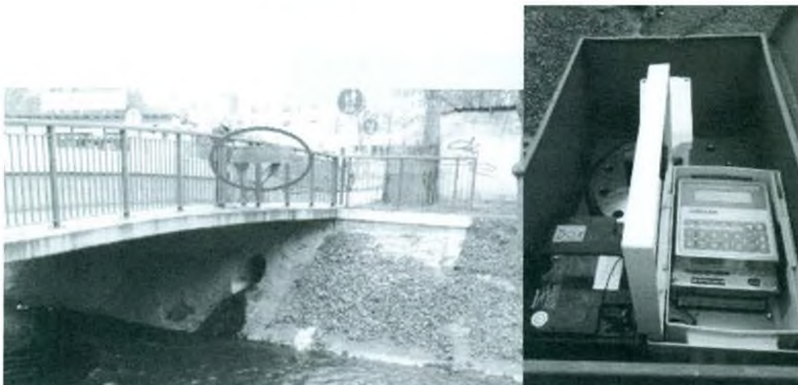
Obrázek 4: Umístění telemetrické jednotky a měřicího čidla do sdruženého skříně; zdroj ČHMÚ
