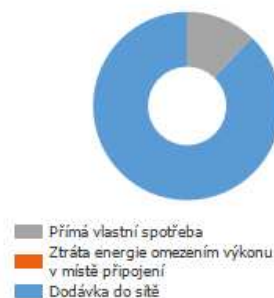
Energetický výnos FVE (AC síť) s baterií
