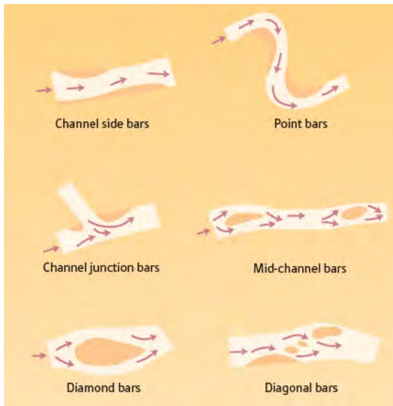
Obr. 63: Typy lavic: střídavé (i v upravených korytech, nejméně stabilní), zákrutové (jesepní), výústní (přítok přináší sediment), střední (málo stabilní, zpravidla za překážkou), diamantové (stabilnější, může se uchytit i vegetace), příčné (narušení diamantových); obrázek převzat z Holden (2017)
