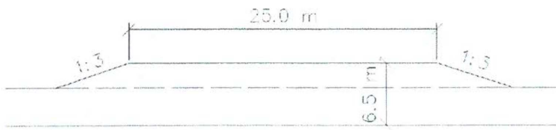
Obrázek 3 – schéma výhybny na jednopruhovové lesní cestě
