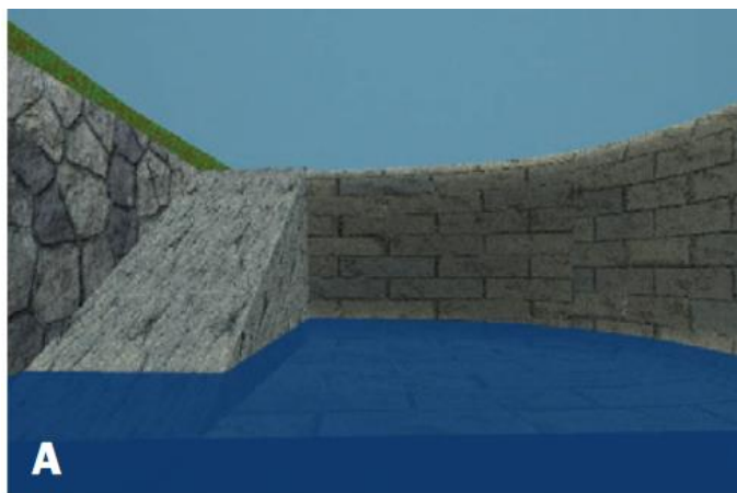
Obr. 3: Jednoduchým způsobem zprůchodnění většiny samostatných bezpečnostních přelivů u rybníků je instalace postranní rampy. A – pohled od průchodu, B – celkový pohled na bezpečnostní přeliv. Převzato z metodiky Vydra a doprava (Hlaváč a kol., 2017). Řešení zprůchodnění bezpečnostních přelivů je vždy navrženo a propočítáno projektantem (aby byla zachována kapacita přelivu a bezpečnost vodního díla) a vodoprávně posouzeno. Reálné provedení představuje obr. 4 vlevo.
