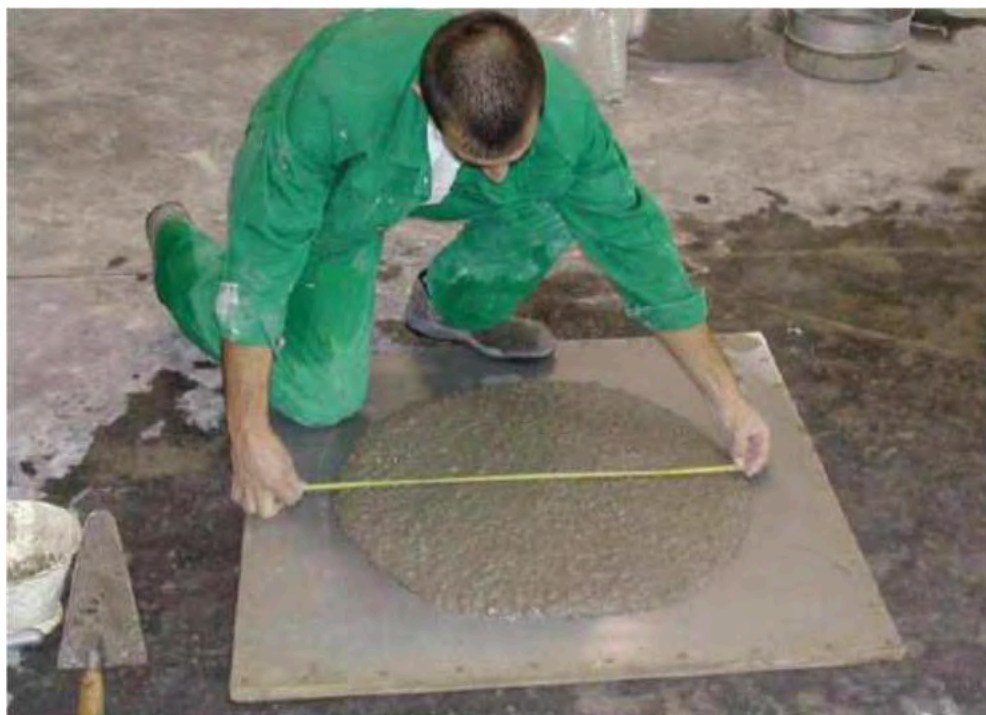
(3) Obr. 3 – Zkouška rozlití SCC - správně navržená směs
