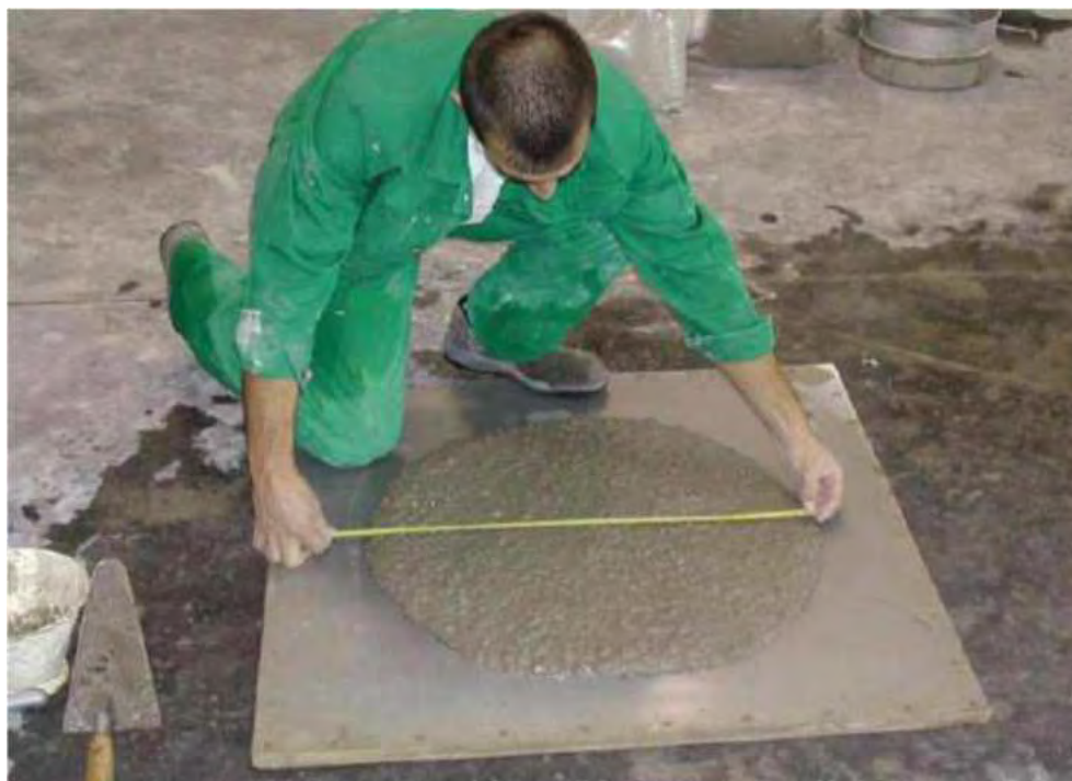
(3) Obr. 3 – Zkouška rozlití SCC - správně navržená směs
