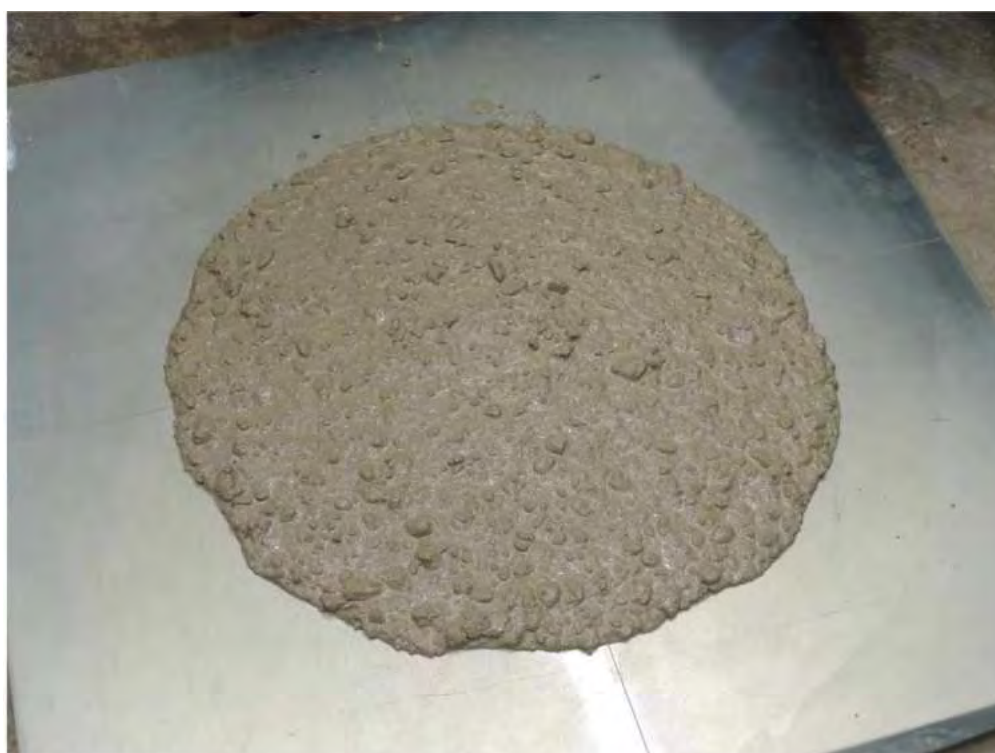
(4) Obr. 4 – Zkouška rozlití SCC - správně navržená směs, bez náznaku bleedingu, segregace, rozlití 560 mm - směs bude málo pohyblivá
