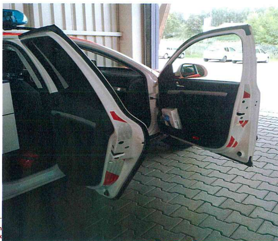
Bezpečnostní prvky na hranách otevřených dveří – požadavek přední dveře řidiče a spolujezdce
