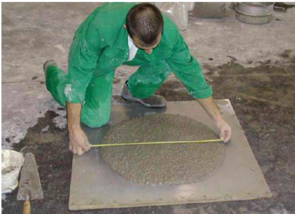
(3) Obr. 3 – Zkouška rozlití SCC - správně navržená směs
