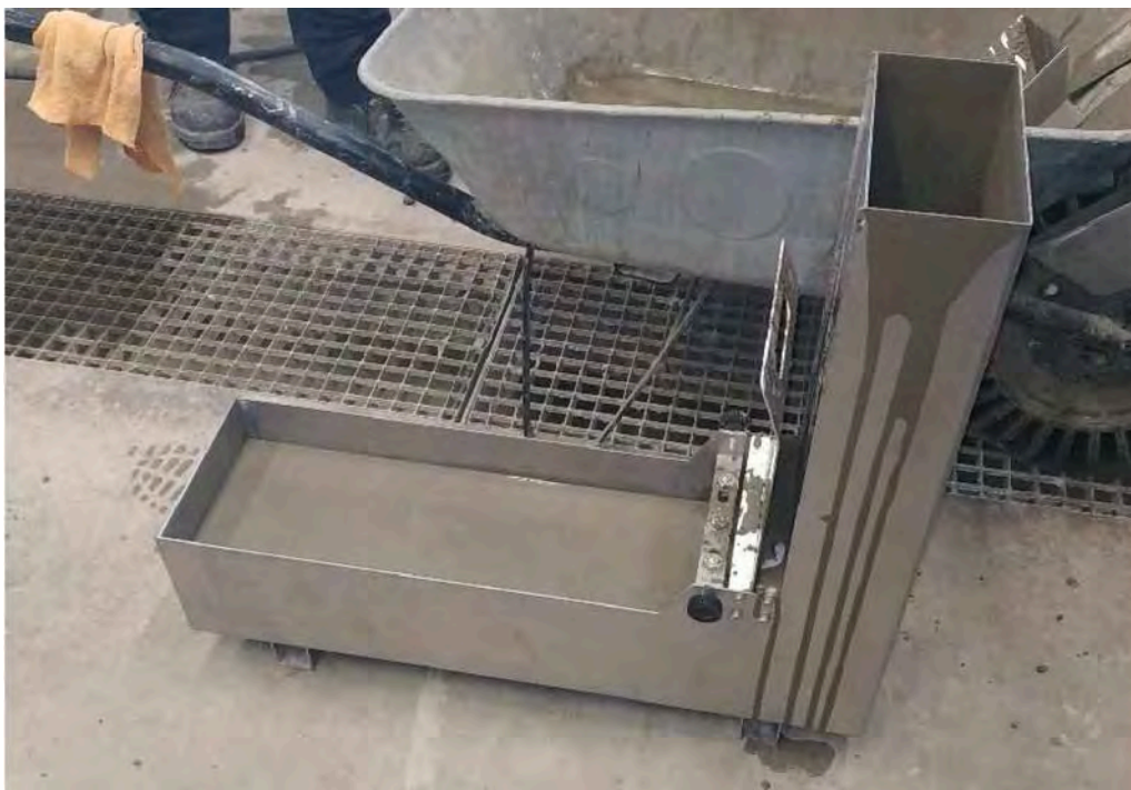
(9) Obr. 9 – Zkouška SCC L-truhlíkem – nesprávně navržená směs, vysoká náchylnost k bleedingu a segregaci (na povrchu pouze cementové mléko bez kameniva)
