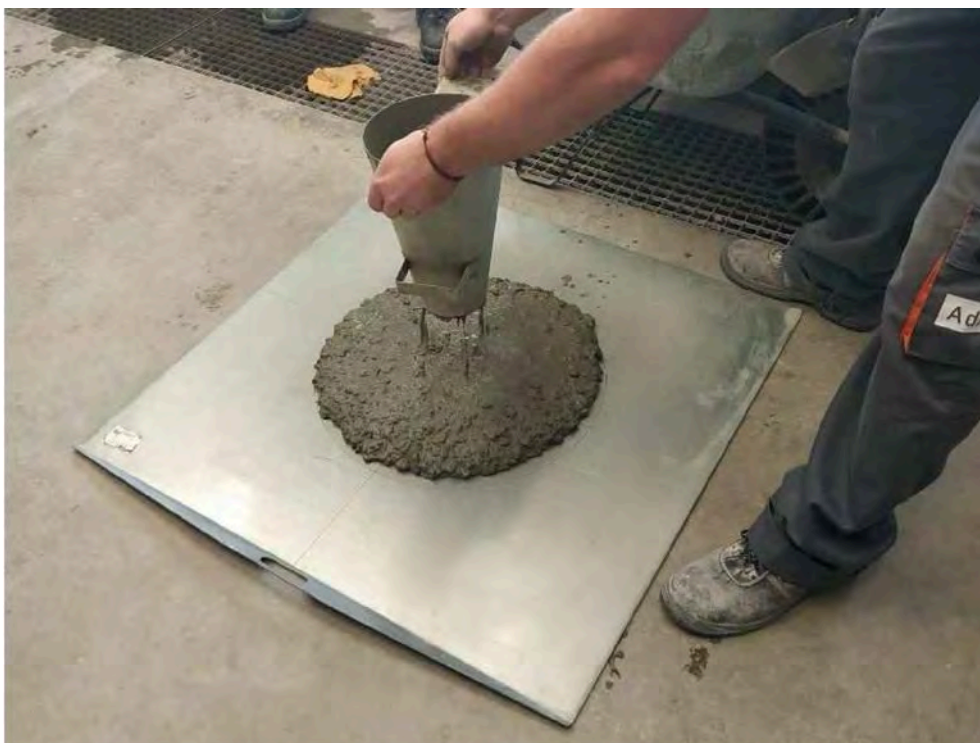
(2) Obr. 2 – Zkouška rozlití směsi SCC metodou obráceného kužele (dále jen Zkouška rozlití SCC)
