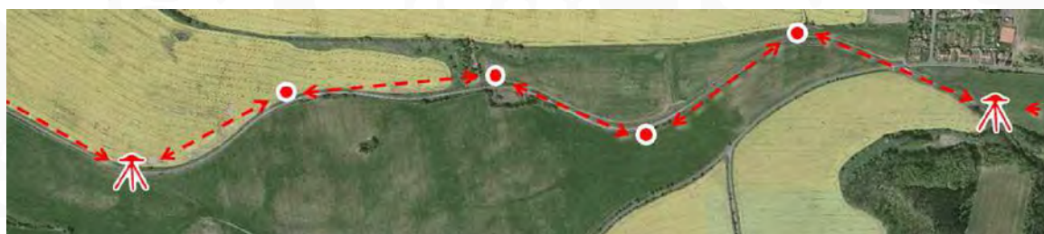
Obrázek 1 Polygonové body mezi dvěma body primární sítě
