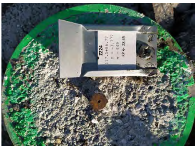
Obrázek 33 Roxor v betonovém bloku (základní odlehčená stabilizace)
