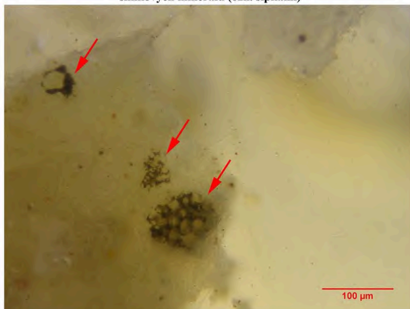
Obr. 2: Praha – Hradební – vrstva 2 – identifikace fragmentů nezhydratovaných slínekových minerálů (ozn. šípkami)
