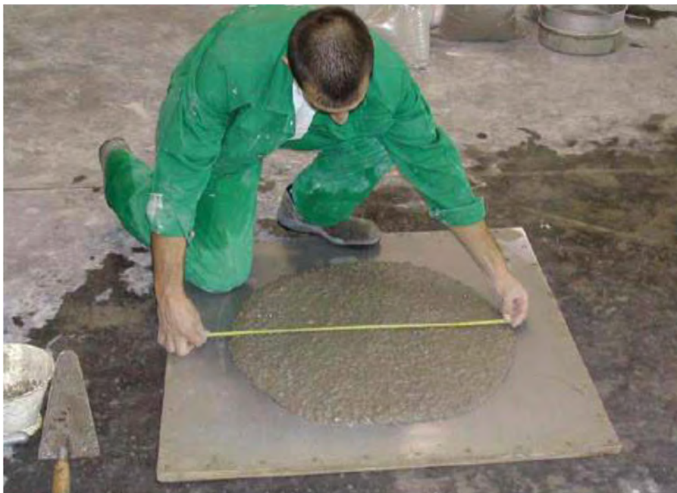
(3) Obr. 3 – Zkouška rozlití SCC - správně navržená směs
