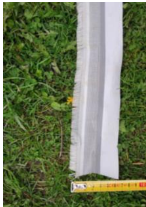
Alternativní vhodný trvanlivý materiál pro zvýraznění oplocenek – páska s výstužnou tkaninou (ořezy z výroby auto plachet)
