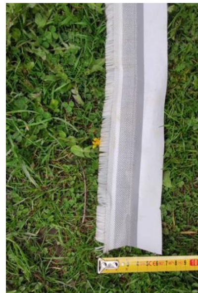
Obrázek 2 Alternativní vhodný trvanlivý materiál pro zvýraznění oplocenek – páska s výstužnou tkaninou (ořezy z výroby auto plachet)
