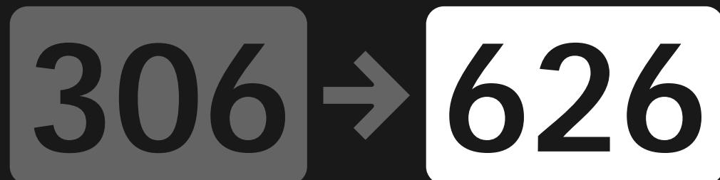
Obrazovka se zobrazí při přejezdu vozidla na jinou linku (tzv. návazný spoj). Kromě základního textu obsahuje také obě čísla linek (současné a nové). Tato obrazovka jako jediná (vyjma startovací) zabírá celou plochu (nezobrazuje se číslo linky s konečnou zastávkou, řádek se sledem zastávek ani příští zastávku).
