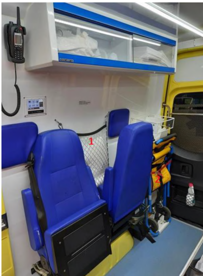
1 zádržný systém pro uložení zavazadel pacientů 2 umístění transportního křesla
