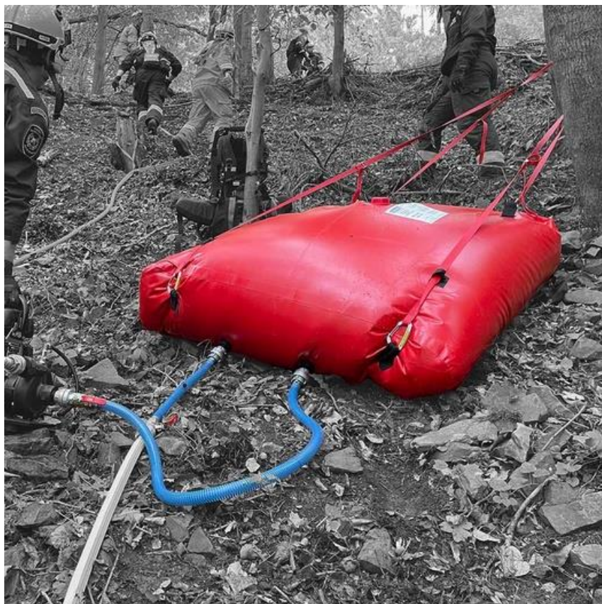
Obr. 2 GTX UN 500 l – pomocná skládací gumová nádrž na vodu
