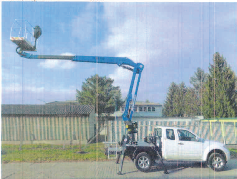
Boční dosah při plném vysunutí teleskopického ramene dle zátěže
