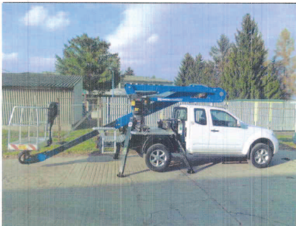
Možnost spuštění koše až k zemi se sníženou zátěží
