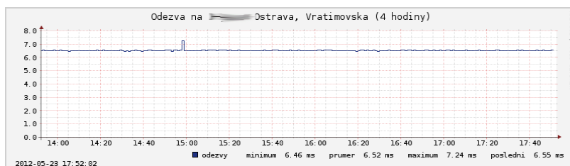
Obr. 4: Příklad statistiky Odezva – Zpoždění paketů (Delay)
