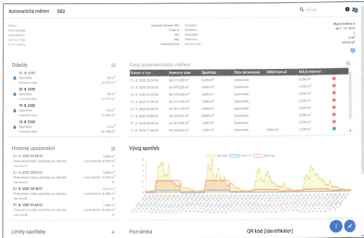
Obrázek 16 – Detail dálkového měření na vybraném měřidle
