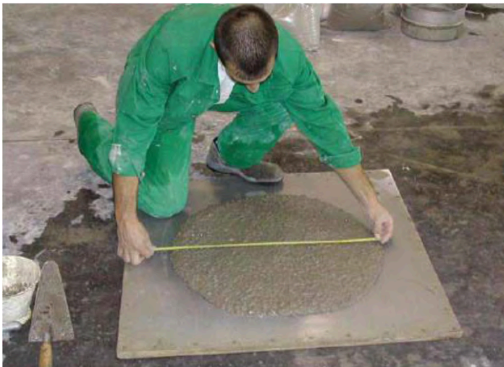
(3) Obr. 3 – Zkouška rozlití SCC - správně navržená směs
