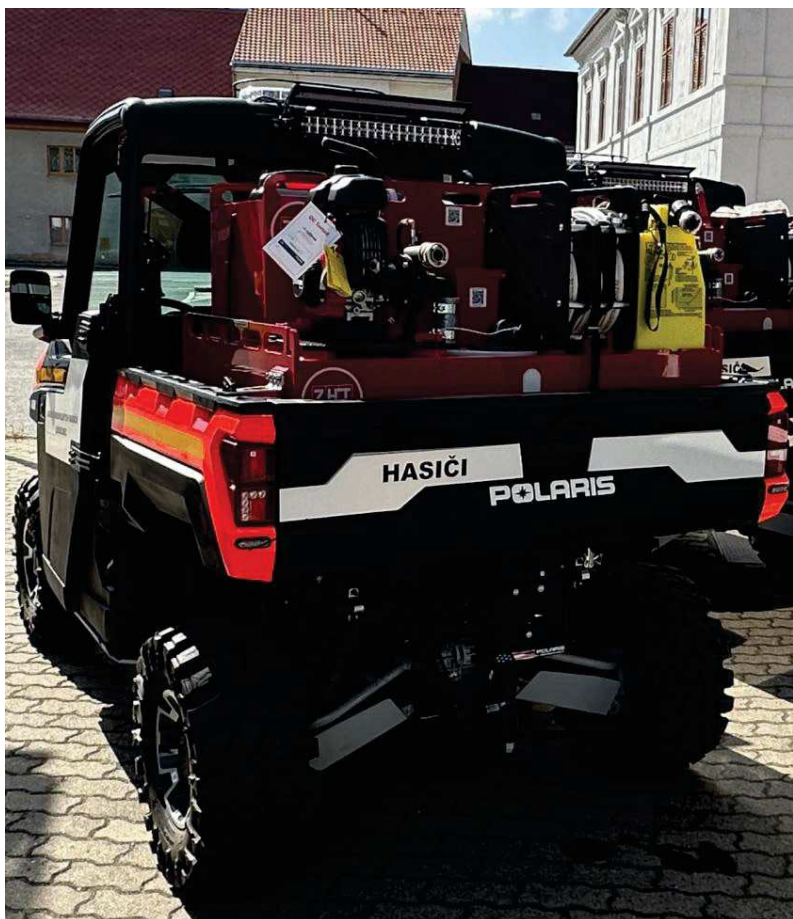
LED rampa zadní s ochranným krytem, 6D, 120W + 12W, délka 55cm, 8400 lm , krytí IP67, životnost 50.000h
