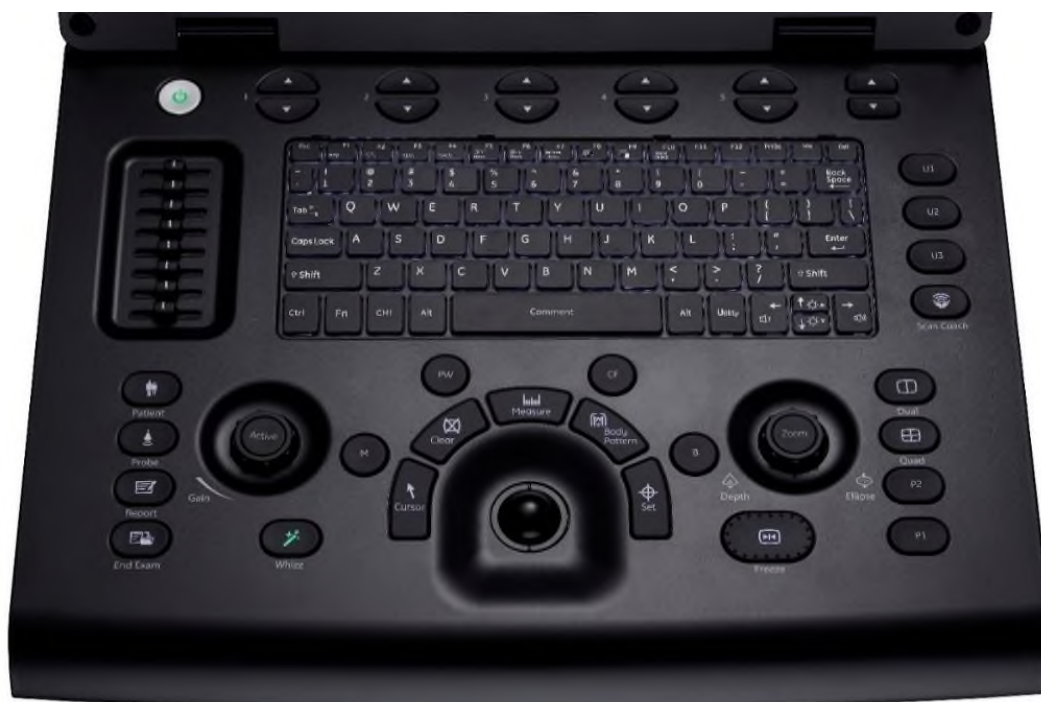
Obr. č. 2: Detail ovládacího panelu a funkce Whizz (kontinuální automatická optimalizace)
