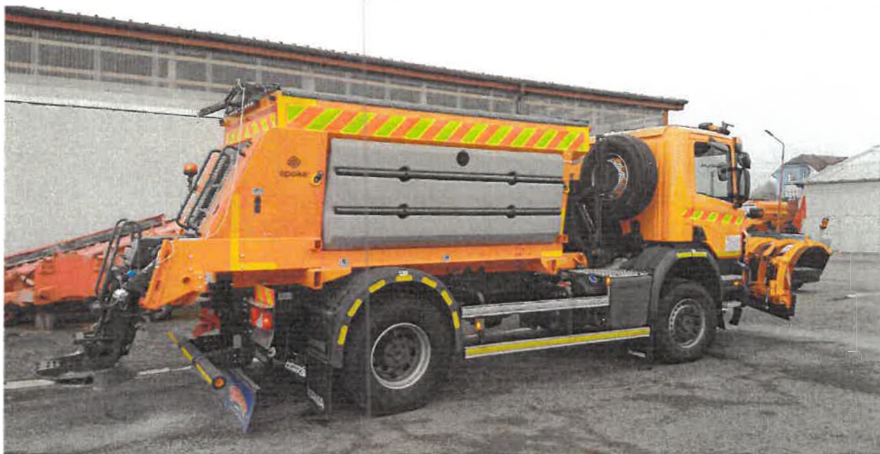
Vyobrazení velikostní varianty zásobníku M s nádržemi na solanku 2 x 1 200 l na SCANIA 4x4
