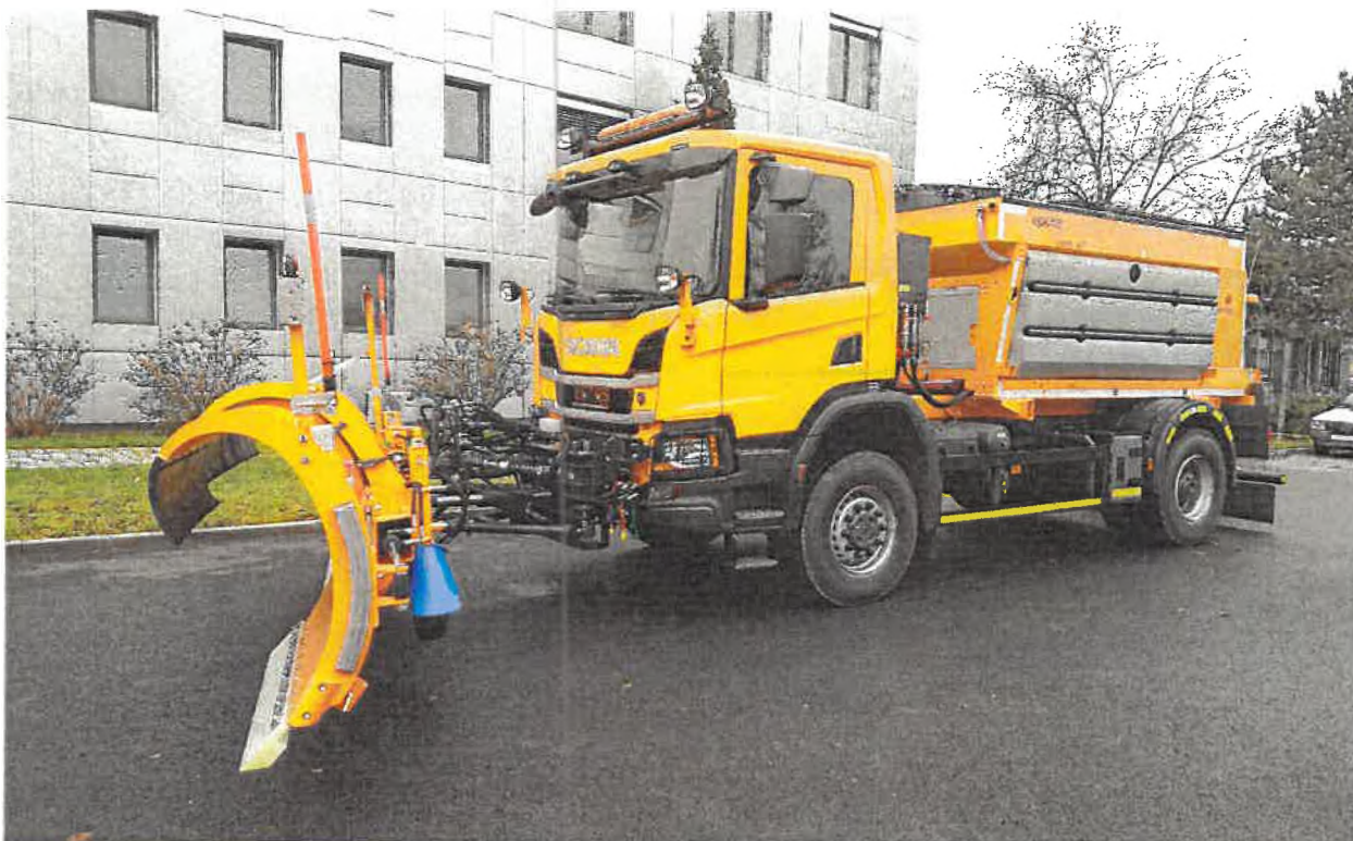
Provedení sypače EPOKE SK3810 SIRIUS AST 5m3 na podvozku SCANIA 4x4
