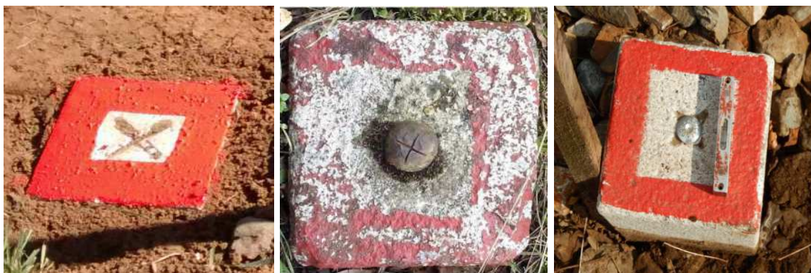
Obrázek 6 Hlava kamene s vysekaným křížkem, se zabetonovaným nivelačním znakem a s měřickým hřebem (zleva)
