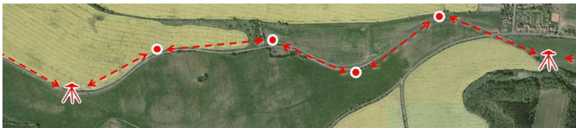
Obrázek 1 Polygonové body mezi dvěma body primární sítě
