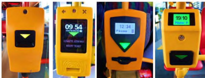
Obrázek 14: Příklad provedení označovače jízdenek (NJ 24C, Camel-Combi, SU 52, ETM 4.0)
