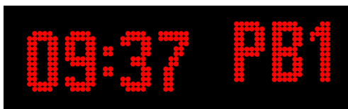
Obrázek 12: Zobrazení informací na zobrazovači času a pásma
